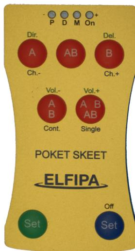
dopo l'ultima chiamata il dispositivo si spegne automaticamente se in 'Single' o continua in 'Cont.' fino alla pressione del Tasto **BLU** 'Off'; il dispositivo si spegne comunque, se non c'è nessuna chiamata, dopo 3 minuti di inattività.
